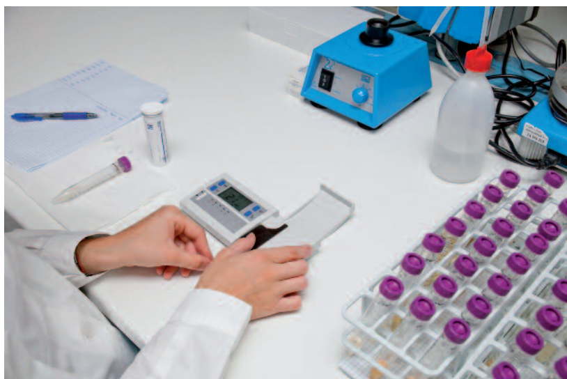
Misura dell'umidità (in alto) e misura dell'HMF (sopra) con metodo reflectoquant. (Foto Lorenzo Piana)
